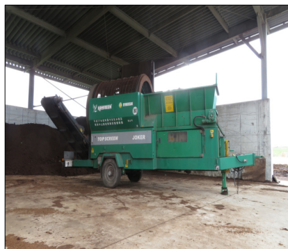
平成17年に導入された機械写真は、堆肥の雑物を除去するスクリーン
