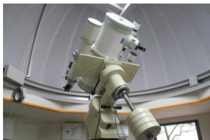
天体愛好家団体が寄贈し、「うぶやま天文台」に設置された口径25cmの反射望遠鏡「産山村ハシエ（イブシロン）250」と呼ばれる口径25cmの反射望遠鏡。望遠鏡を覆う直径3mのドームや、観測目標の天体に望遠鏡を自動で合わせられる架台の設置など事業費1106万円をかけた。
